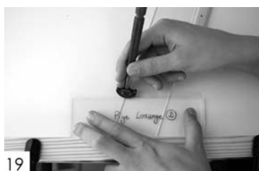
19 Poser la pige sur la bande de verre et couper les losanges, les uns après les autres...
