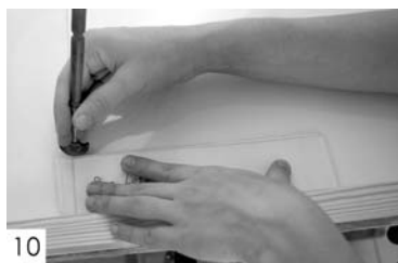
10 Poser la pige sur le verre et positionner le coupe verre.
